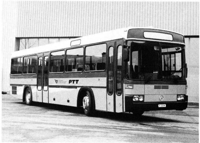
Fig. 4 Überlandbus 1, Chassis Mercedes O 405, Aufbau Ramseier & Jenzer, Biel – Bus suburbain 1 avec châssis Mercedes O 405 carrossé par Ramseier & Jenzer, Bienne
