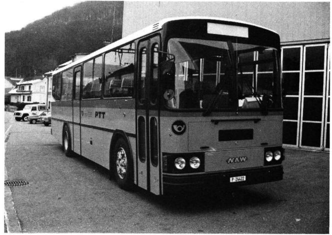
Fig. 6 Touristischer Linienbus auf Chassis NAW BH4-23, Aufbau durch Frech-Hoch, Sissach – Car de ligne touristique avec châssis NAW BH4-23 et carrosserie Frech-Hoch, Sissach
