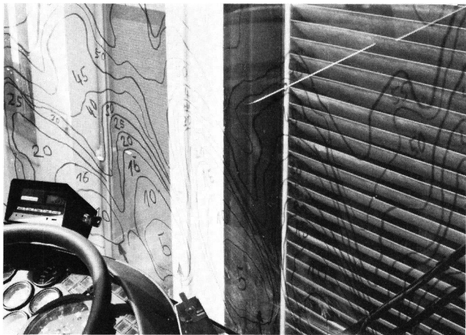
Fig. 16 Entfrosterungstest im Windkanal der Behr in Stuttgart. Prüfung des Verlaufs der Enteisierung der Frontscheiben – Test de dégivrage dans la soufflerie de la maison Behr, à Stuttgart, et examen du dégivrage du pare-brise
