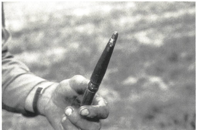
Fig. 10 Die zum Ausspülen verwendete Hochdruckdüse mit «Jet-Effekt»
