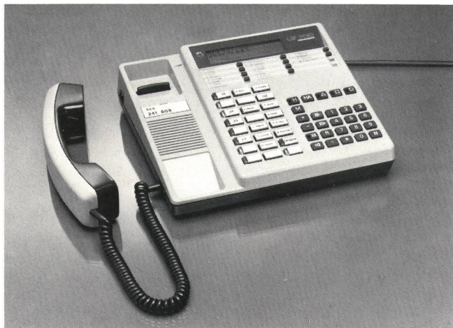
Fig. 1 L'appareil LW 700 Commerce est un sélecteur de lignes avec fonction mains libres incorporée et possibilité de sélection de 20 destinations externes à l'aide des touches de mémoire.
