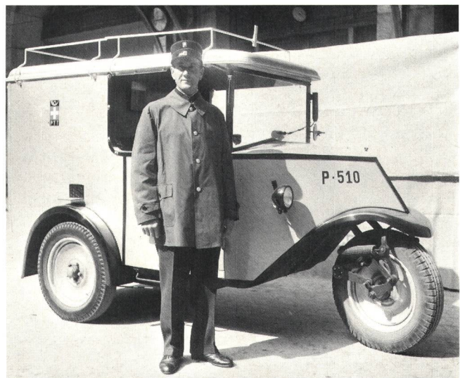
Fig. 1 PTT-Elektrodreirad für Eilzustellung der Marke Tribelhorn
