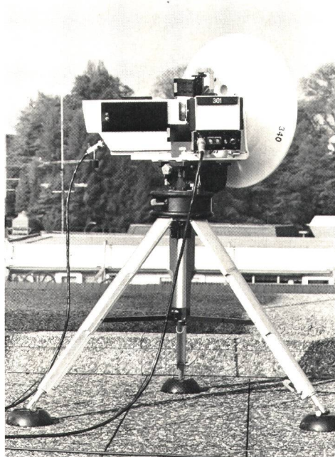
Fig. 11 Eine betriebsbereite mobile TV-Richtfunkstation mit zwei GLOBAL-IX-Sendern im (1+1)-Betrieb
