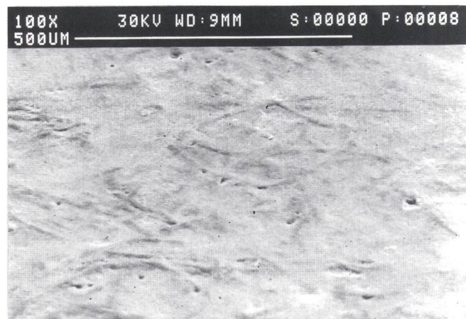
Fig. 2 Oberfläche eines gestrichenen Papiers (Zeitschriftenpapier) unter dem Rasterelektronen-Mikroskop
