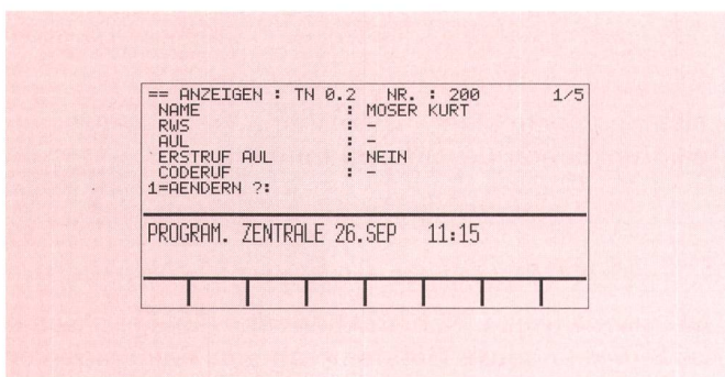
Fig. 3 Erste Menüseite der Teilnehmeranschlussprogrammierung
