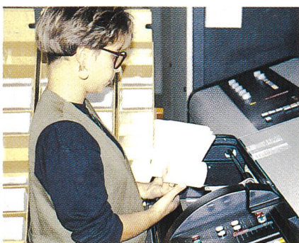
Bild 3. Optischer Belegleser: Am Monatsende durchlaufen täglich 3 bis 4 Mio Ein- und Auszahlungsscheine mehrere solcher Anlagen. Mit hoher Geschwindigkeit werden die Zeichen in den Codierzellen gelesen und auf Mikrofilm aufgenommen, dann werden die Daten über die Zentraleinheit auf Magnetplatten geleitet.
