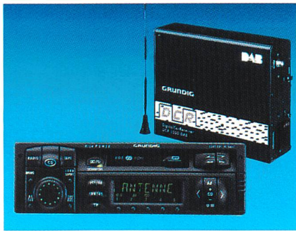
Bild 5. DAB-Pilotempfänger-Set (nur Audio, Grundig-Empfänger).
