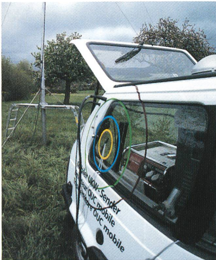
Bild 3. Für die lückenlose Rundspruchversorgung wird ein mobiler UKW-Sender in Betrieb genommen.
