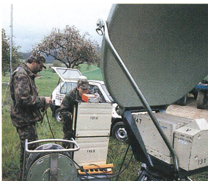
Bild 4. Angehörige der Telecom-Brigade nehmen eine Richtstrahlverbindung in Betrieb.
