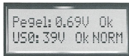
Bild 2. Die So-Bus-Versorgungsspannung und die Impulshöhe der ISDN-Signale liegen innerhalb der vorgeschriebenen Grenzen.
