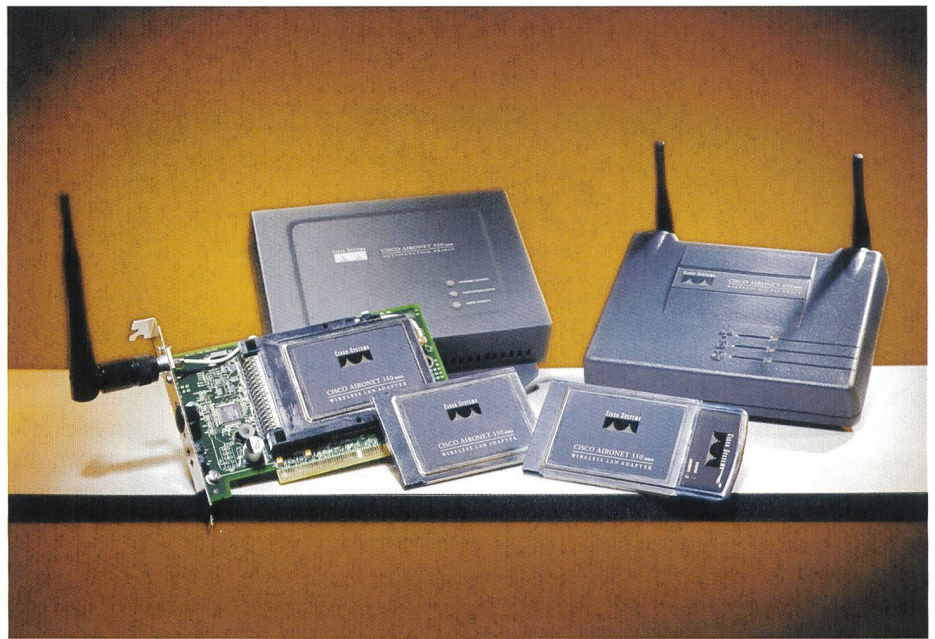
Bild 7. Gerätefamilie Cisco Aeronet 350 zur Realisierung von WLANs. Hinten im Metallgehäuse: Wireless Bridge 352 für Site-to-Site-Verbindungen (AIR-BR350-E-K9). Hinten mit zwei Antennen: Wireless Access Point 352 (AIR-AP352E2C). Vorne links: PCI-Karte für Desktop-PC (AIR-PCI352). Vorne Mitte: LMC-Karte für Geräte mit PCMCIA-Slot, jedoch externer Antenne (AIR-LMC352). Vorne rechts: PCMCIA-Karte für Laptops (AIR-PCM352). Anmerkung von Cisco: Alle Geräte verwenden einen Schlüssel mit 128 Bit.
