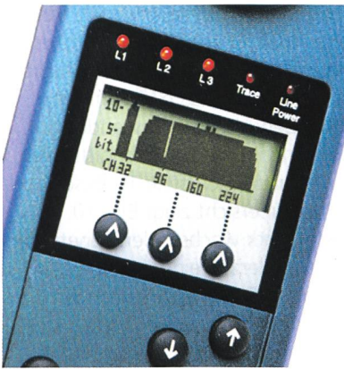
Bild 6. Das Display zeigt die tatsächlichen genutzten Träger für Up- und Download.
