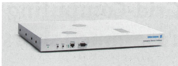
Zweigstellen anbinden: IP-Telefonie-Gateways verbinden herkömmliche Telefonie mit der Signalisierung per Internet Protocol
