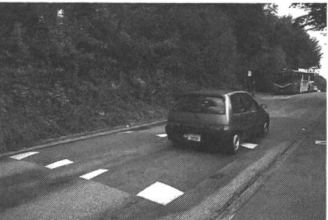
Zuchwil: Buslinie durch Tempo-30-Zone. Die paarweise angeordneten «Bus-Kissen» beruhigen den Verkehrsfluss, ohne den Bus zu behindern.
