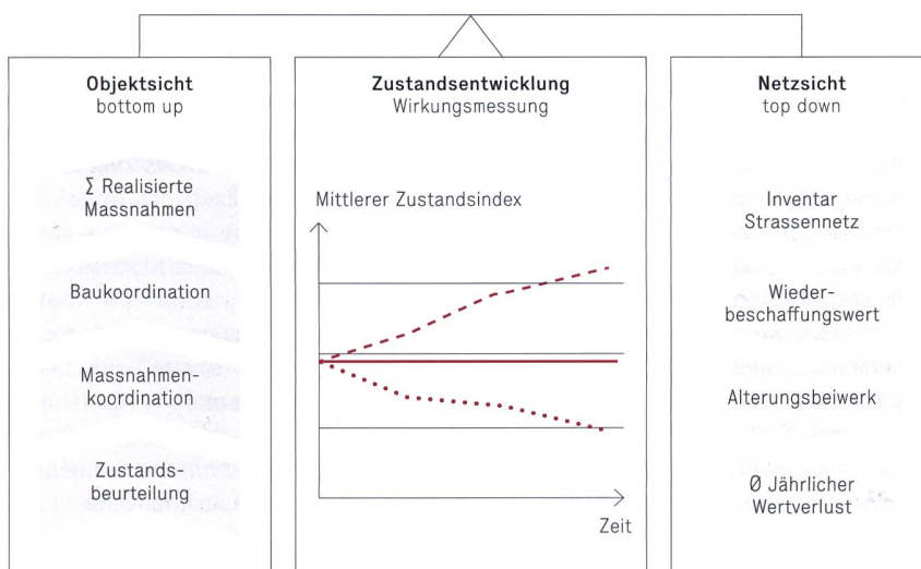
[ABB. 3] Grundmodell Werterhalt (Quelle: Leitfaden für Politiker und Praktiker: Werterhalt von Strassen, Schweizerischer Gemeindeverband, Juni 2005)
