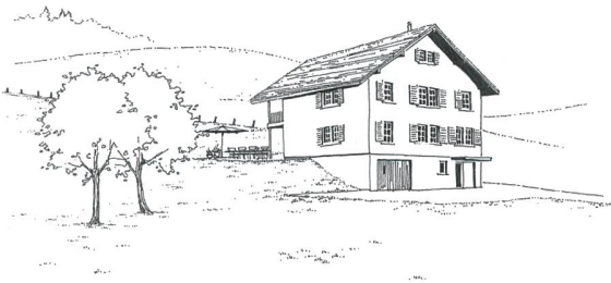
[ABB. 2] Landschaftlich wenig sensibel sind Lösungen mit unschönen Stützmauern, meist mit Absturzsicherung. Viel besser eingepasst sind nicht zu steile Böschungen.
