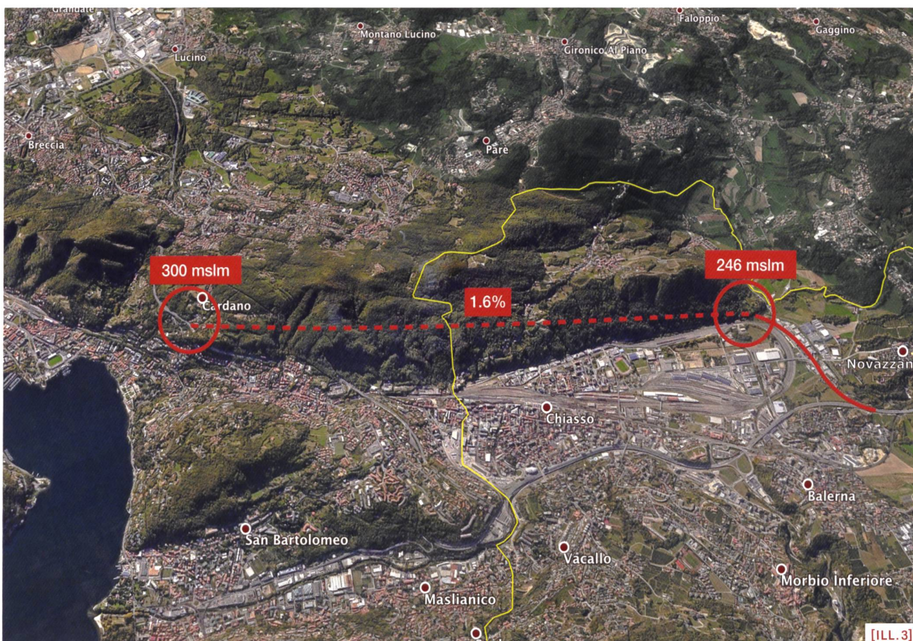
[ILL. 3] Tratta tunnel con verifica altimetrica. (Fonte: Elena Fontana)
