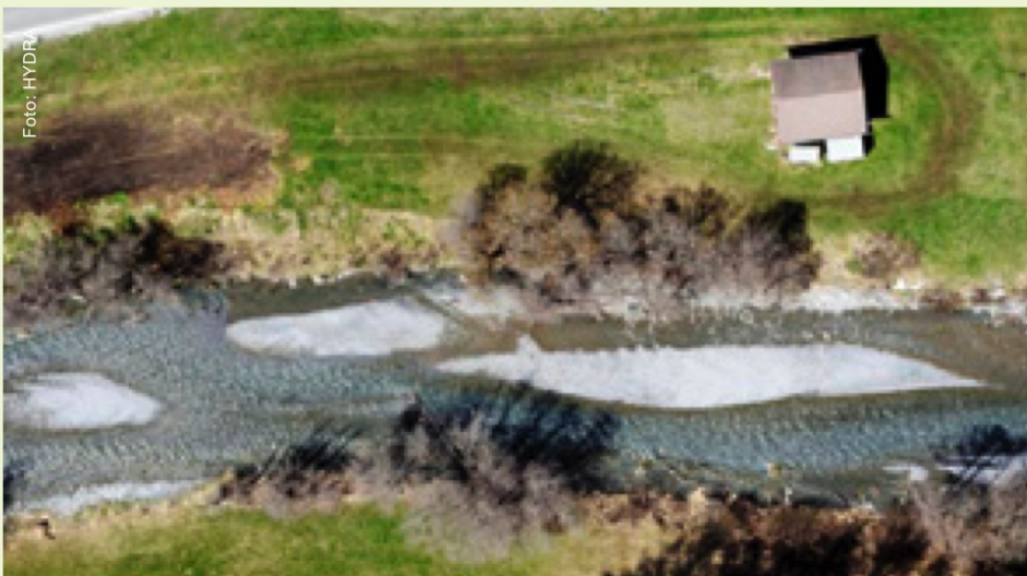
Abbildung 2 Spöl oberhalb Holzbrücke Zernez: Bei der Spülung wurden die Kiesablagerungen erodiert. oberes Bild: 06.05.2009 unteres Bild: 05.08.2009
