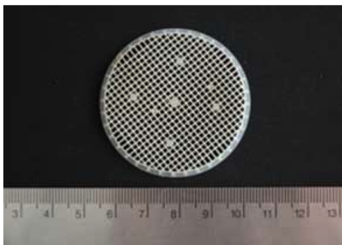
Biofilter aus Plastik, welche aus der Kläranlage Samedan in den Lai da Ova Spin gelangten.
