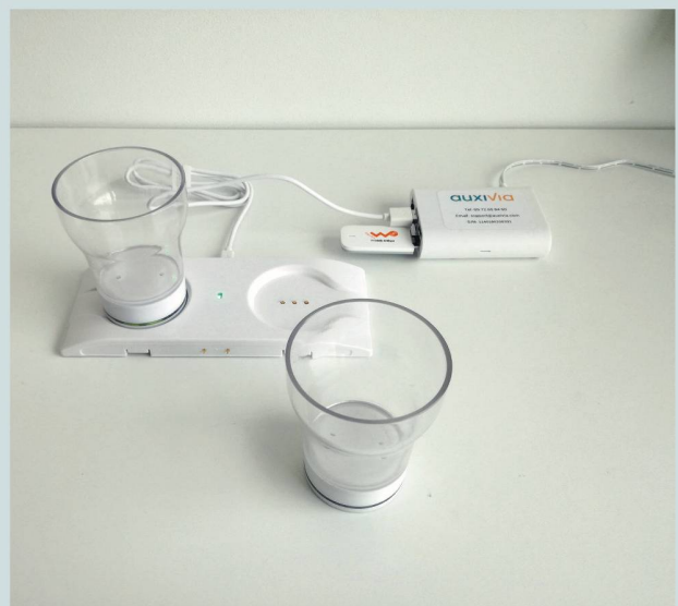
Le verre connecté est équipé de puces à sa base, qui enregistrent les données nécessaires. Photo: Auxivia
