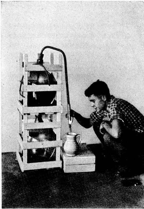
Ausschank mit Siphon (Leistung 12 Liter pro Minute)
