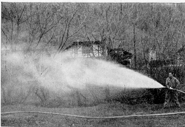
Sprühstrahl eines Mehrzweckrohres, das ebenfalls mit Vollstrahl und Mannschutzbrause arbeitet.
