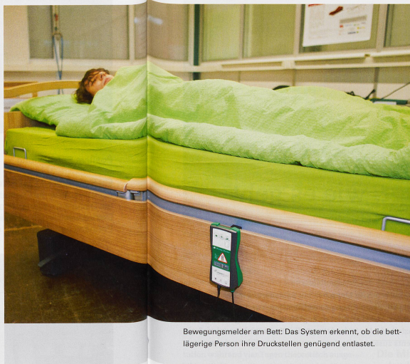
Der Sensor unter der Matratze misst berührungslos feinste Bewegungen und sendet die Daten auf das Display am Bett.
