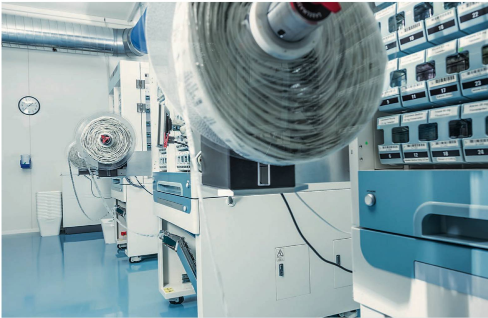
Die Produktionsmaschinen verpacken pro Monat über eine Million Pillen in Plastikbeutel, die pro Bestellung aneinanderhängen und auf Spulen aufgerollt werden.
