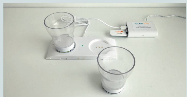
Das vernetzte Glas ist mit Chips bestückt, die alle nötigen Informationen analysieren und speichern.
