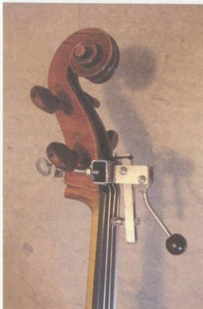
Von Valentin Altorfer/ Simple Mechanik und Moritz Müllenbach entwickelter Metallfinger, mit dessen Hilfe sich ansonsten unspielbare Passagen in Xenakis' «Kottos» ausführen lassen. Foto: Moritz Müllenbach
