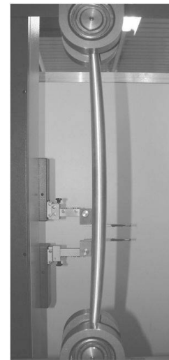
Abb. 16 Knickstab in Zugmaschine unter Last.
