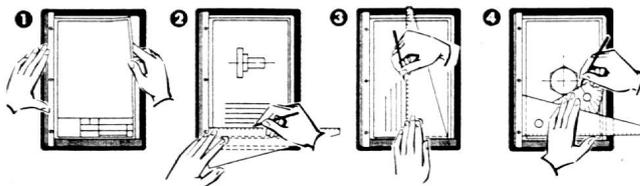
1) Une pression sur la barre de serrage suffit pour fixer ou libérer chaque feuille, même non perforée. 2) Pour tirer les horizontales : l'équerre spéciale applicable à l'extrême bord glisse automatiquement contre la barre d'appui. 3) Pour tirer les verticales : la longue équerre spéciale permet de les dessiner d'un seul trait. 4) Les angles courants de 15, 30, 45, 60 et 75° se font avec l'équerre spéciale (15/75°) et l'auxiliaire (45°).
