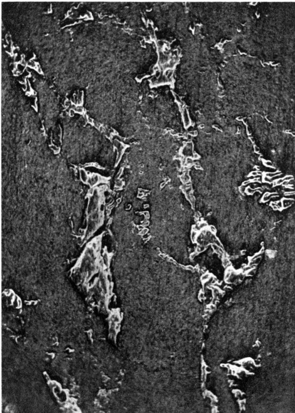
Fig. 3. Anshl., 14:1. Brackwasserkalk, Abbau-Feld Dx-10 über Grundstrecke II-S, Kote 1808. Kalkige, kohlig durchstäubte Grundsubstanz mit Nestern und tropfenartigen Einschlüssen von Kohle (Randreflexe).
