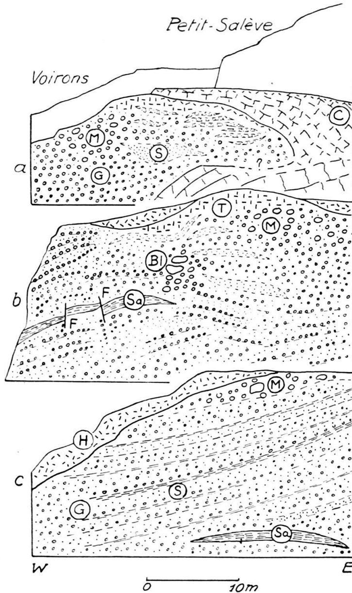
Fig. 1. Trois profils à travers les graviers du retrait glaciaire, stade de Veyrier. a) - Carrières du Pas de l'Echelle. b) - Gravières Achard. c) - Gravière de Sous-Balme. La distance entre a et c est de 800 m.
