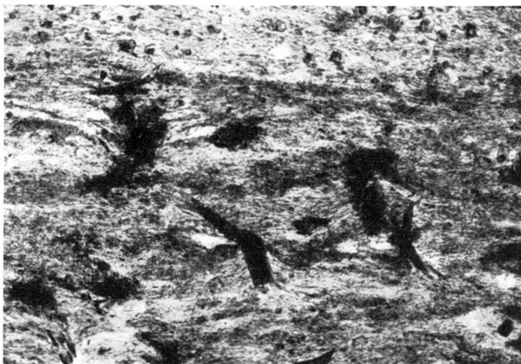
Fig. 5. Metamorpher Chloritoidschiefer (= Quartenschiefer). Grundmasse = Chlorit und Quarz, darin schöne Chloritoidbüschel. Undrau Südsporn (27 ×).
