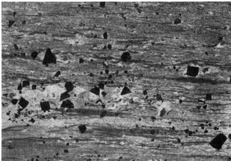
Fig. 12. Magnetit-Chloritschiefer = metamorpher Eisenoolith des Callovien. Die Magnetitkriställchen liegen in einer sehr quarzarmen Kalzitgrundmasse. Der Chlorit ist parallel zur Schieferung in schmalen Streifen angeordnet (Chlorit = dunkelgrau). Undrau Nordsporn (8×).
