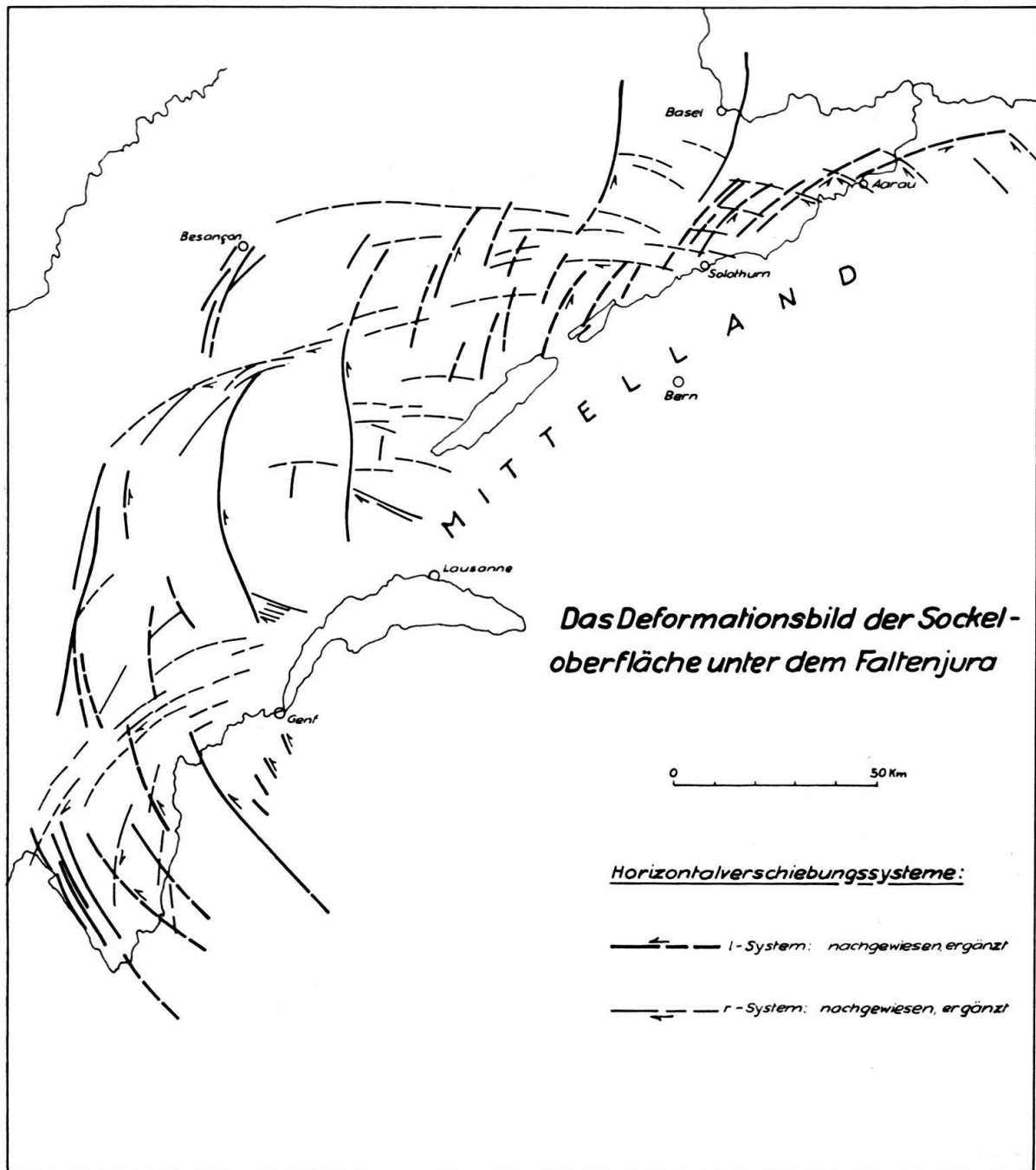
Fig. 5. Analyse des Faltenbildes des Faltenjura nach dem Prinzip der HV-Faltung, schematisierte und vereinfachte Darstellung. Ausgezogene Linien: Brüche und Horizontalverschiebungen an der Oberfläche sichtbar. Gestrichelte Linien: Horizontalverschiebungen abgeleitet aus dem Faltenbild.
