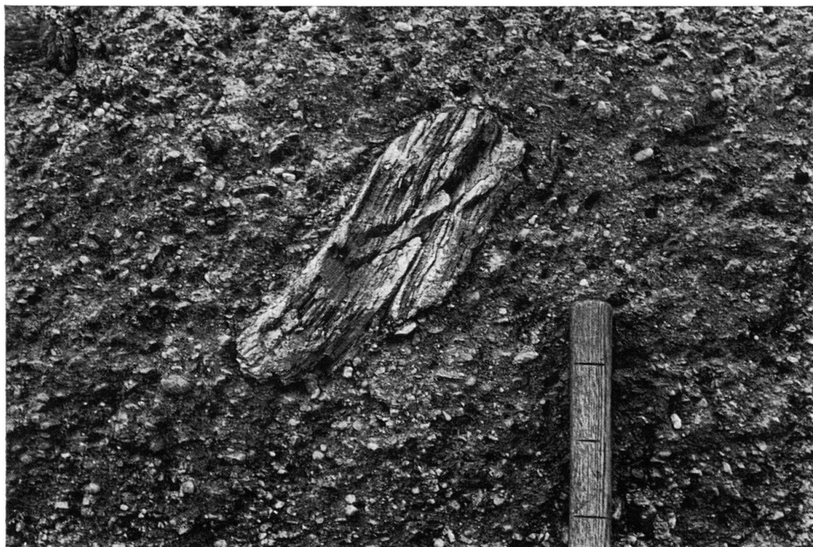
Fig. 2. Stück eines gutgeschichteten, leicht zerreiblichen, quartären Sand-Siltes, eingeschlossen in feinkörnigem massigem Kies. Die Kieskomponenten «schwimmen» in einer sandig-siltigen Grundmasse. Abstand der Kerben auf dem Hammerstiel 5 cm. Kiesgrube ob der Station Reichenau–Tamins.
