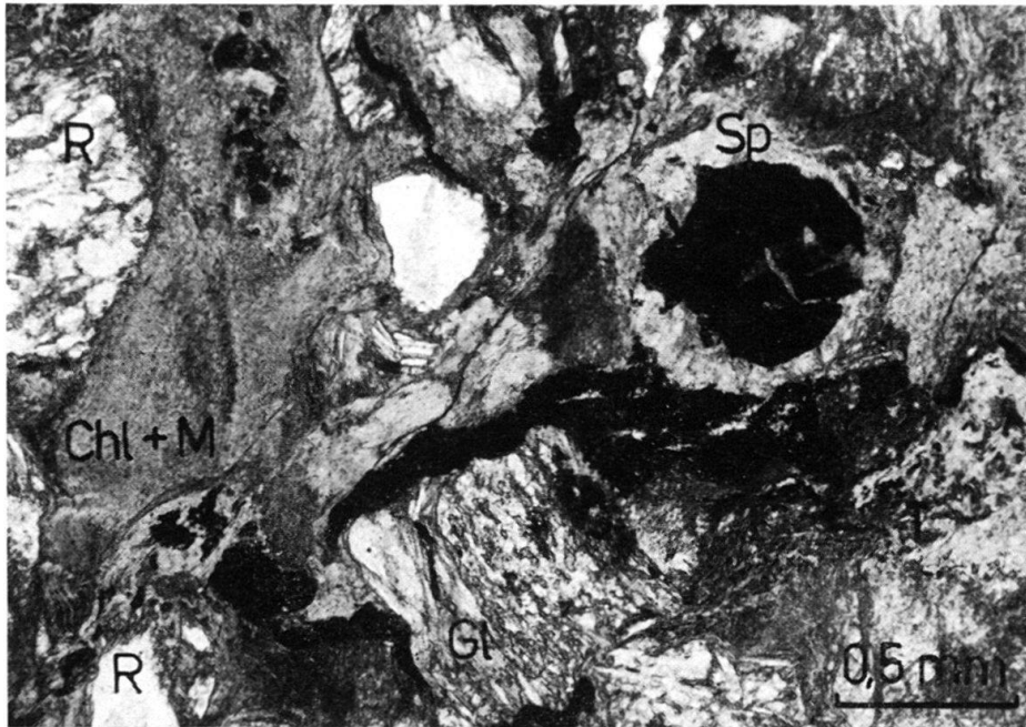
Fig. 4. Polygene Radiolaritbreccie. In grüner, feinfilziger Matrix (Ripidolith (Chl), Muskovit (M), Hämatit und Titanit (T)) liegen kleine Radiolaritbruchstücke (R), Quarzit und Glimmerschieferkomponenten (grau mit Paralleltexur, Gl) sowie Spinellkörner (schwarz, meist Magnetit, Sp). Vergrößerung 35 ×, ohne gekr. Nicols.
