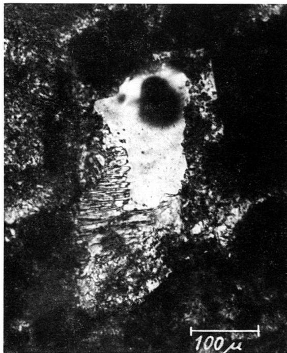
Fig. 7. Detritischer Quarz; rechts oben authigen weitergewachsen, links unten durch Calcit ersetzt. LM pol., DS 30/8u.
