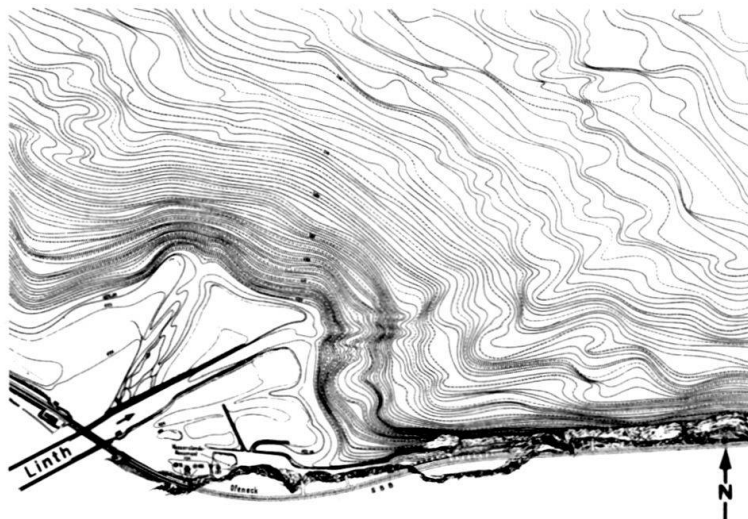
Fig. 7. Ausschnitt aus der Seegrundkarte von 1911 (COLLET & STUMPF 1916), verkleinert auf 1:10000. Vor der nach Osten mündenden Linth sind am Deltahang subaquatische Rinnen zu erkennen, die W-E gerichtet sind. Der nach NNE gerichtete (abgeschnittene) Mündungsarm ist eine Folge des Hochwassers von 1910, als die Linth unmittelbar nach der Eisenbahnbrücke den linken Damm durchbrach.
