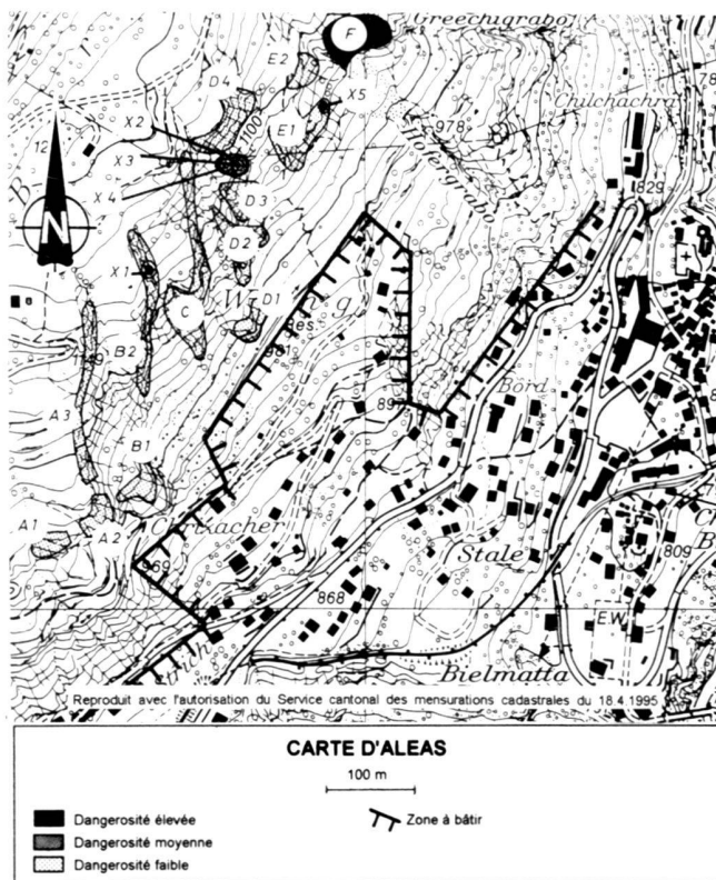
Fig. 8. Carte d'aléas. Chaque aléa est flanqué d'un code qui renvoie à une fiche descriptive où sont consignés mécanisme de mobilisation, volume des compartiments, taille des blocs, etc.
