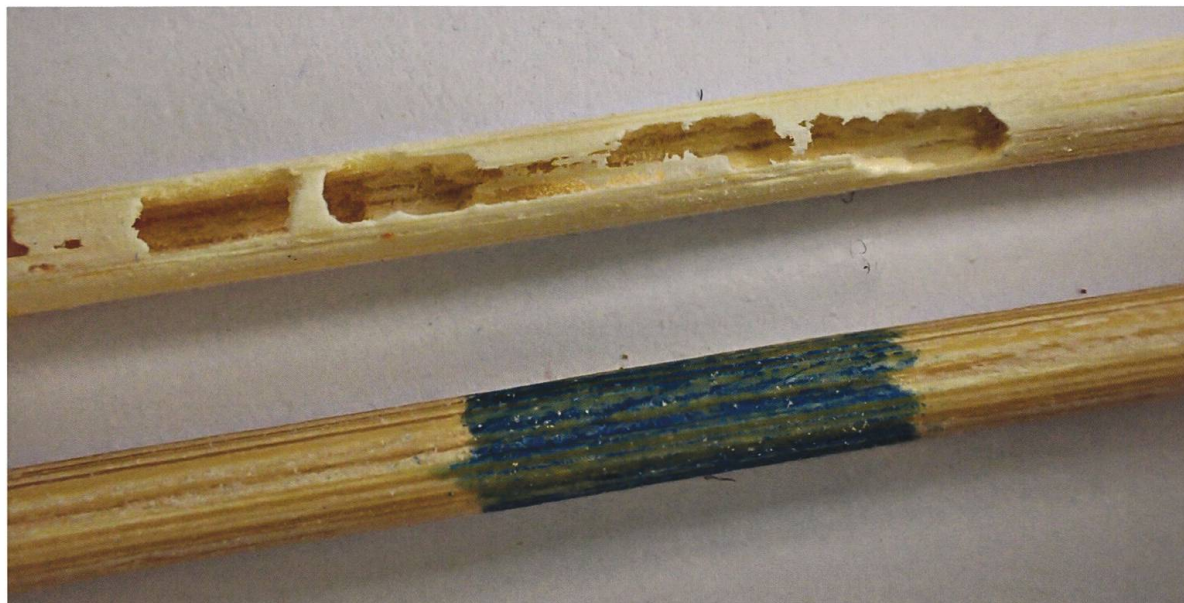
Abb. 2. Mikado-Stäbchen aus Bambus mit Frassspuren von Dinoderus minutus . (Foto C. Germann)
