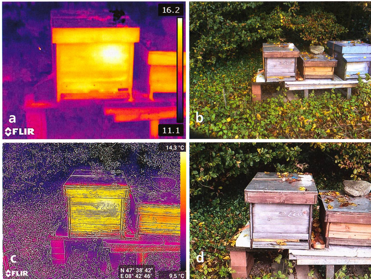
Abb. 3. Thermografien a, c ) und Fotografien b, d ) der jeweils selben Bienenkästen, um die Kameras «E60» und «S61 Cat» zu vergleichen. Bewohnt ist von allen 3 Kästen nur derjenige ganz links, wie man auf der Thermografie der Kamera «E60» a ) dank der weisslichen Stelle gut erkennt. Auf der Thermografie der Kamera «S61 Cat» c ) ist diese Stelle aber kaum auszumachen. Was auf den Thermografien ausser der erwähnten Stelle sonst noch leuchtet, wurde nicht von den Bienen verursacht, sondern lediglich von der Sonne angewärmt. (Fotos David Hablützel)
