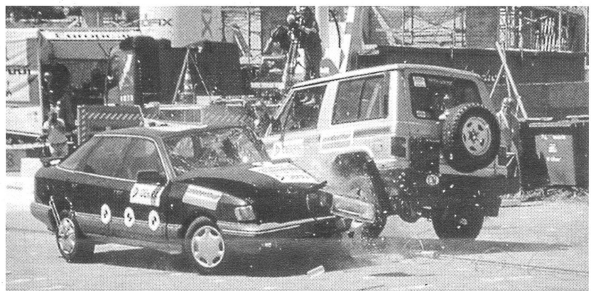
Crash-Test der Winterthur-Versicherungen: Normale Personenwagen haben keine Chance gegen die stahlharte Karosserie der Geländewagen.
