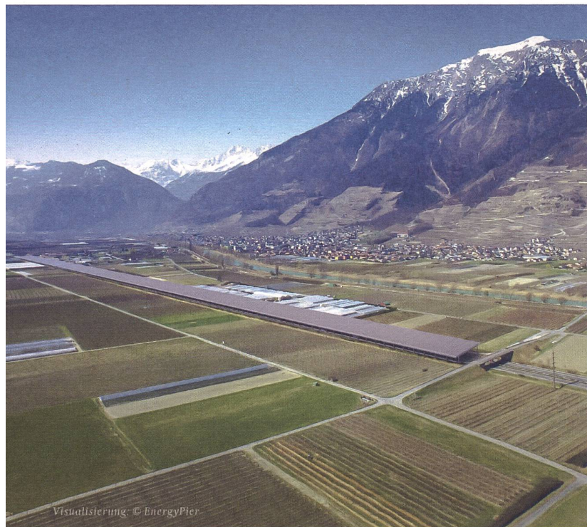
In Fully im Kanton Wallis wird die A 6 auf einer Strecke von 1,6 Kilometern mit Solarpanels abgedeckt, die tragenden Säulen mit vertikalen Windrädern bestückt. Das gibt Strom für 12'500 Haushalte.
