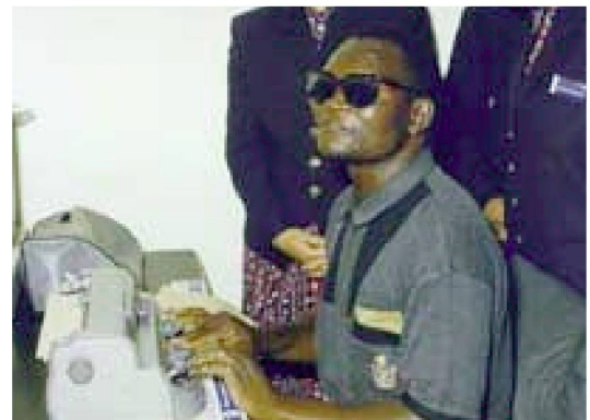
"Perkins Brailier" 0Punktschrift-Schreibmaschine: Stumpfe Nadeln drücken von unten auf das Papier und erzeugen die Braillepunkte.
