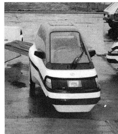
«mini-el»-Fahrzeug mit Thermoplast-Karosserie.
