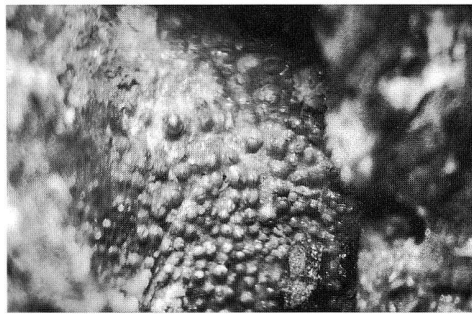
Bild 21: Karbonatische Zinkkondensate (Ofengalmei) am Gewölbematerial des Flammofen-Rösthendes (Mikroaufnahme)
