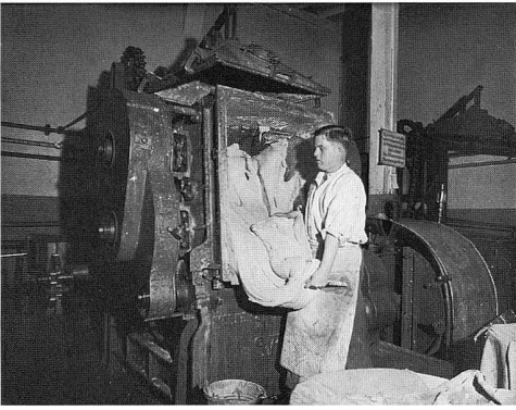
Vakuumneter mit Flügelwellen in der Rheinischen Gummi- und Celluloidwaren-Fabrik um 1920; sie wurden u. a. in der Westdeutschen Celluloid-Fabrik Düsseldorf-Meerbusch bis 1984 eingesetzt. (Dokumentation 1984)
