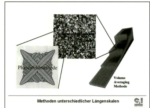
Simulationen für unterschiedliche Längenskalen (von rechts nach links: cm-Bereich, mm-Bereich (10 bis 1000 μm), μm-Bereich (< 10 μm)).
