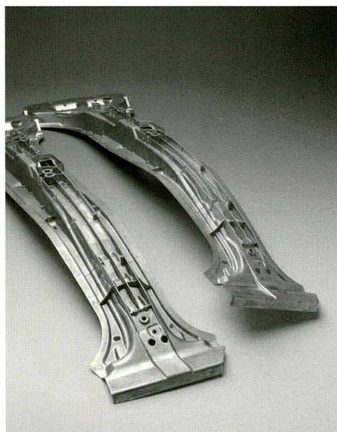
Unterschiede im Verzug am Beispiel B-Säule. Rechts: Glühung bei 490° C x 1 h; Wasserabschreckung. Links: partielle Lösungsglühung mit verzugsarmer Abkühlung.
