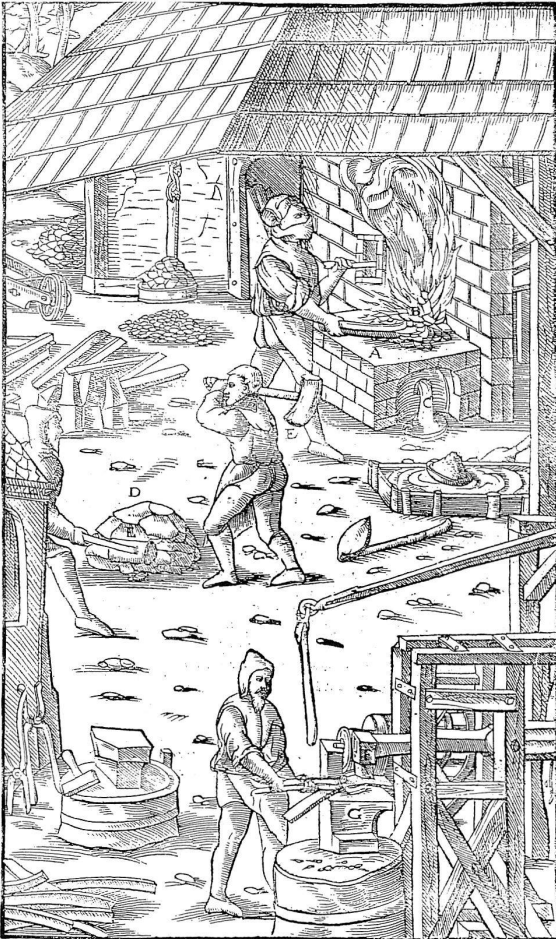
Aber zu dem eisen ärg, das einweder Kupfferig ist oder schwärlicher / so es geschmelze wirt / flussset / muß man mehr arbeit / vñ ein sterckers feur habē / dan scine
